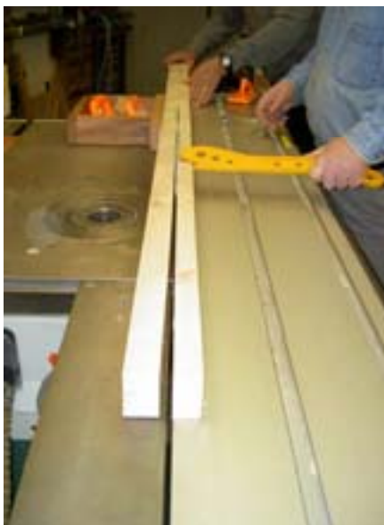
Jauge de réglage de la profondeur de coupe du fer de toupie
