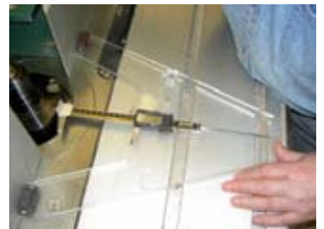
Jauge de réglage de la profondeur de coupe du fer de toupie
