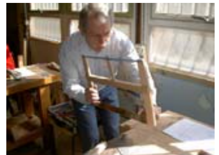
Sciage du tenon – la technique acquise pendant le stage niveau 1 s'avère précieuse en l'occurrence.
