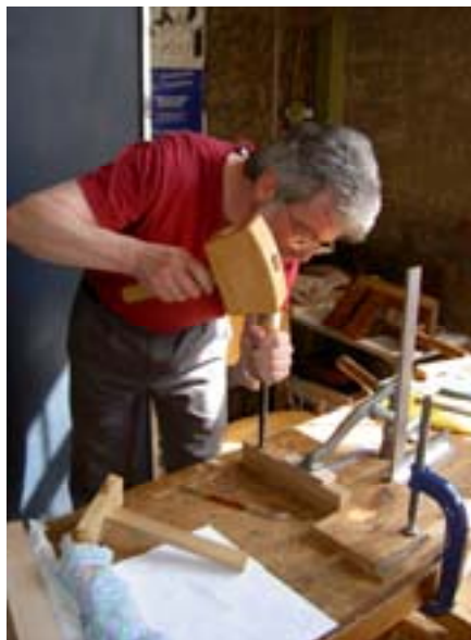
La mortaise est défoncée au bédane et les règles de traçage et la méthode de travail assurent la précision nécessaire
